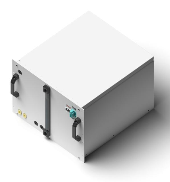
エナプターの水電解装置用給水タンクは容量35リットルで、標準的な19インチラックに搭載可能です。当社の浄水システムまたはその他の適切な給水源からの純水を入れます。ポンプ装置により、最大7台の水電解装置に純水を供給することが可能です。
