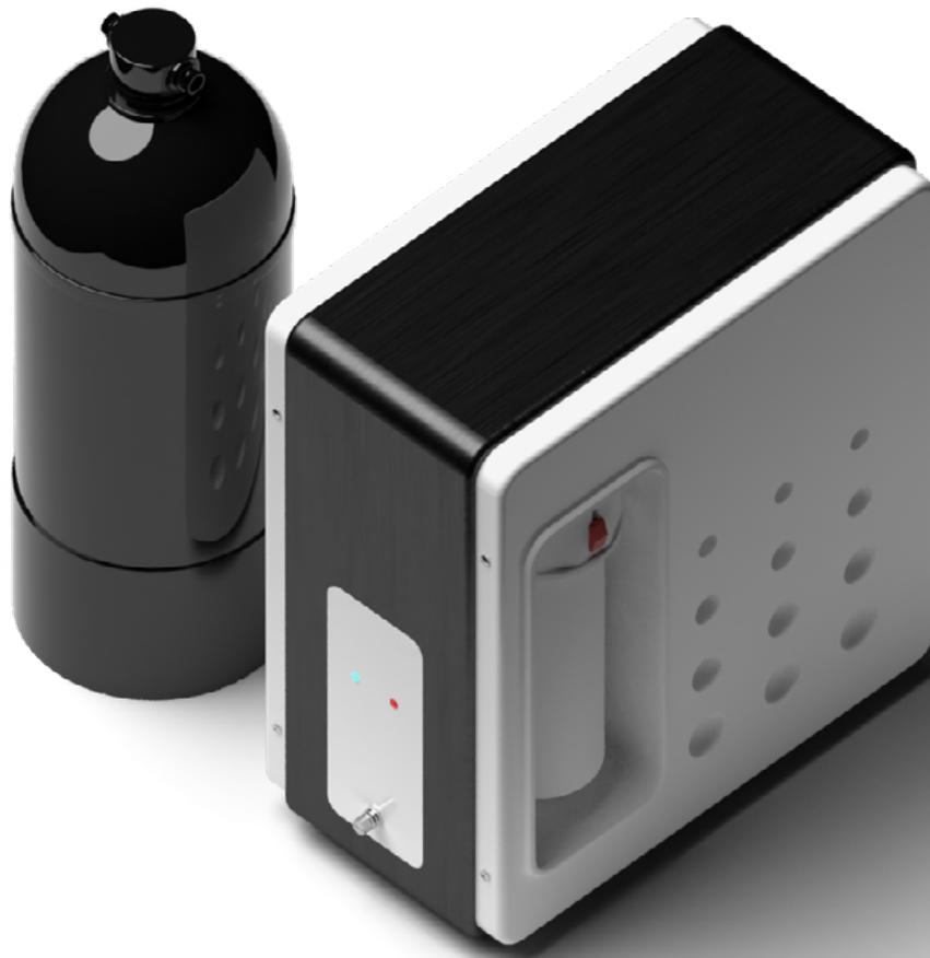
エナプターの水電解水素製造装置は、供給水の水質要件があまり厳しくなく、浄化した雨水や水道水を使用することができます。本製品は、逆浸透 (RO) 浄水に樹脂フィルター処理を組み合わせたシンプルなシステムで、水電解に必要とされる水質をクリアすることができます。当社の水電解装置で使用する給水は、脱塩処理を行い、電気伝導率を  $20\mu\text{S}/\text{cm}$  未満とする必要があります。
