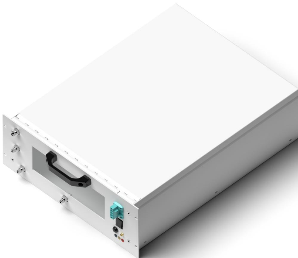
Осушитель водорода Enapter представляет собой гибридную адсорбционную систему, которая состоит нескольких картриджей, наполненных высокоадсорбирующим материалом. Во время работы один картридж улавливает влагу из потока газообразного водорода от электролизера, тогда как другой картридж нагревается при помощи ТЭН и регенерируется. Осушитель устанавливается в стандартную 19" стойку или шкаф.
