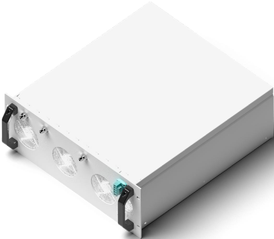
エナプターのドライヤーは、高温と圧力変動吸着法によるハイブリッド乾燥システムを採用。高性能の吸着剤カートリッジ2本を搭載し、メンテナンスフリー。片方のカートリッジが水電解装置から送られる水素ガス中の水分を除去し、その間、もう一方のカートリッジは加熱再生されます。標準的な19インチラックに搭載可能です。
