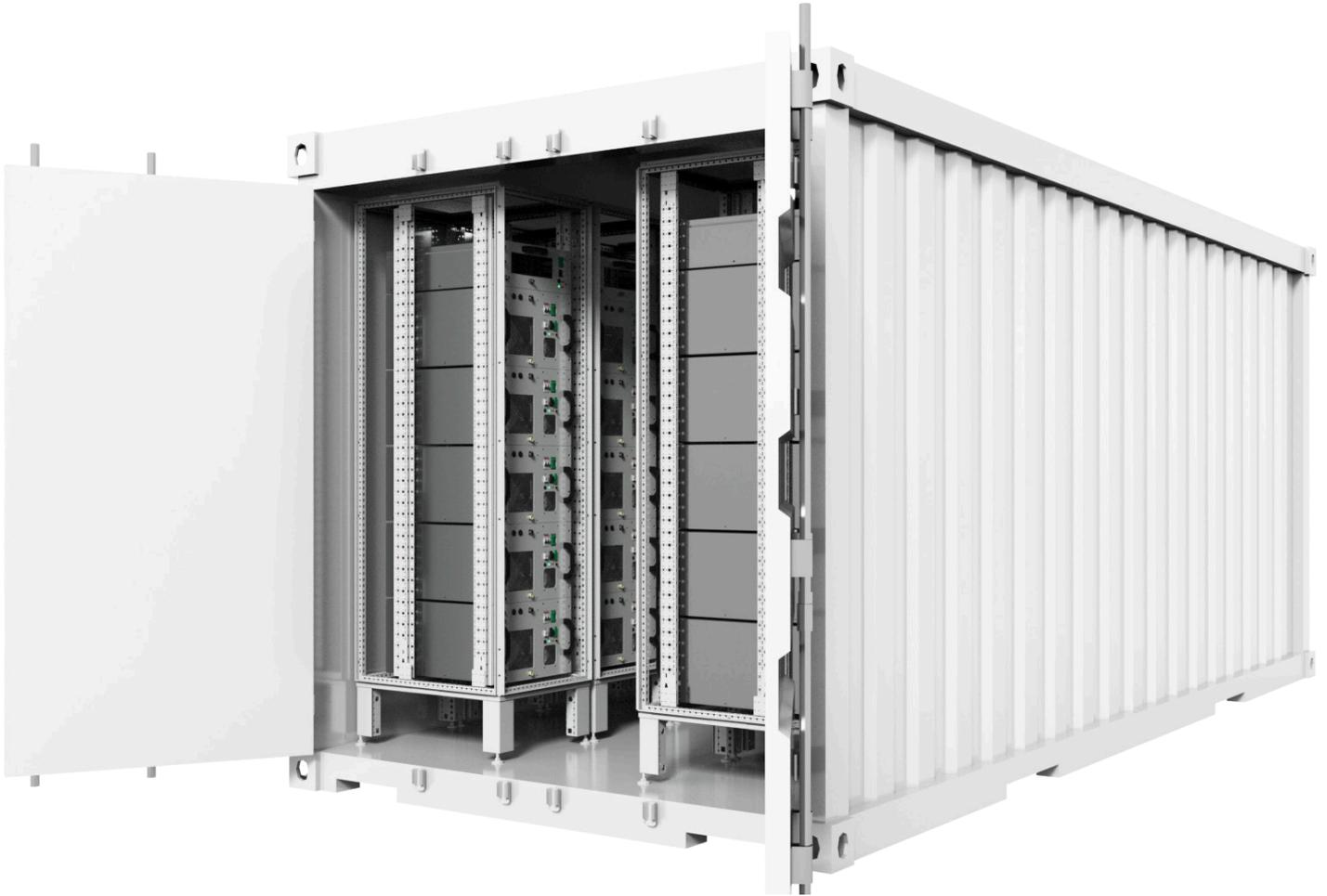
Enapter 的 AEM Cluster 60 是一个完全组装的、可随时运行的、包装在 20 英尺集装箱内的电解槽系统。它提供纯度为 99.999% 的  $30\text{Nm}^3/\text{hr}$  的氢气。现场工程仅限于连接通风和净化管道、供水、氢气出口管道以及电网连接。
